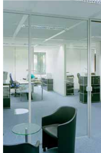
Links ohne Profil gestoßene Glaselemente bei Transparenz pur 10, rechts Glasstoß mit Aluminiumprofil bei Transparenz pur 30
